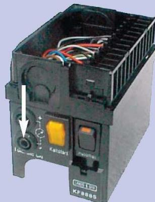
Messanschluss für die Flammenüberwachung
